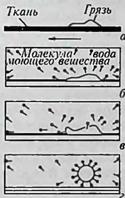
Рис. 26. Схема действия ионов моющего вещества на частицы грязи. а — частица грязи на ткани; б — молекулы моющего вещества в воде присоединяются своими гидрофобными концами к частице грязи; в — молекулы моющего вещества начинают отрывать частицу грязи от ткани; г — молекулы моющего вещества окружают удаленную с ткани частицу грязи и удерживают ее во взвешенном состоянии
