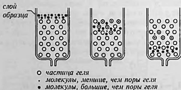
Рис. 6. Разделение двух типов молекул при прохождении через колонку, содержащую частицы пористого геля. Молекулы, размеры которых больше пор, увеличиваются быстрее тех молекул, размеры которых меньше, поскольку последние входят в поры и выходят из них
